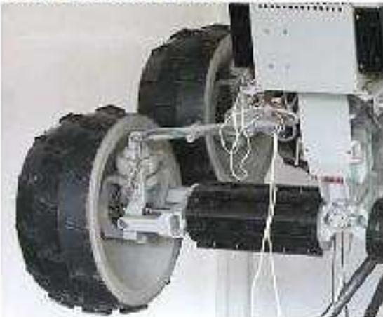
La fonction « transmettre » de la chaîne d'énergie d'une roue est réalisée par un train d'engrenages épicycloïdal composé de deux trains identiques placés en série (on dit deux « étages » de réduction).
