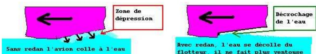
Le redan doit toujours être au moins perpendiculaire au fond du flotteur, toujours pour éviter l'effet ventouse. La cassure doit être franche. A ce propos, il en est de même pour l'arrière du flotteur, et pour les mêmes raisons.
