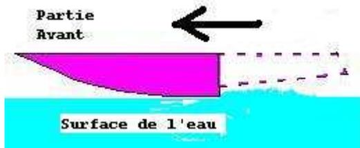
La partie arrière a pour fonction principale de tenir les flotteurs horizontaux lorsqu'ils flottent en déportant vers l'arrière une partie flottante. Elle n'a pas à priori d'autres fonctions utiles car elle n'est plus en contact dès que l'avion accélère, par contre, elle est nécessaire car en raisonnant par l'absurde, si elle n'était pas là, l'appareil basculerait vers l'arrière
