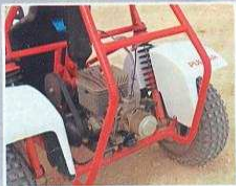
Plusieurs motorisations au choix pour le Pulsar. Ici un 340 cm 3 Sach à variateur.
