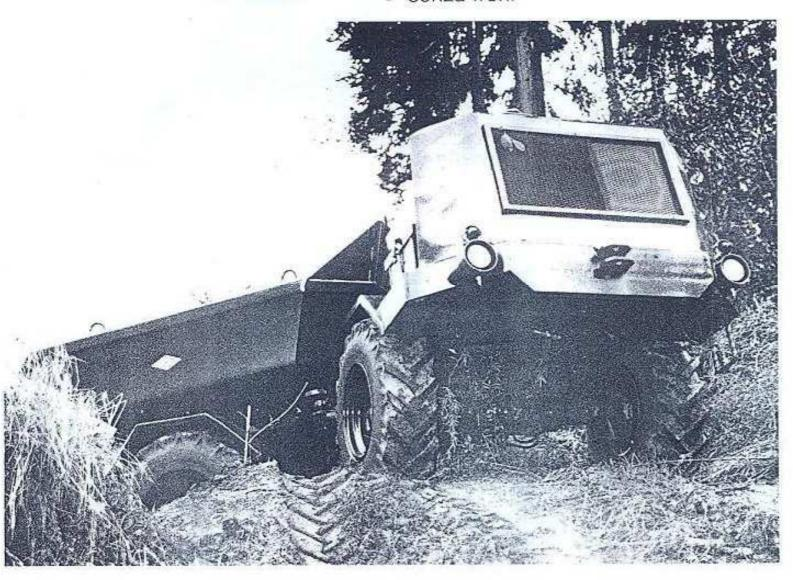
caratteristiche del LEOPARD 2000 raggio di sterzata: esterno 3 m., interno 1,25 m. telaio a doppia articolazione ottime prestazioni in salita, anche a pieno carico senza freni - può superare ogni pendenza cassone ribaltabile a 90°.
