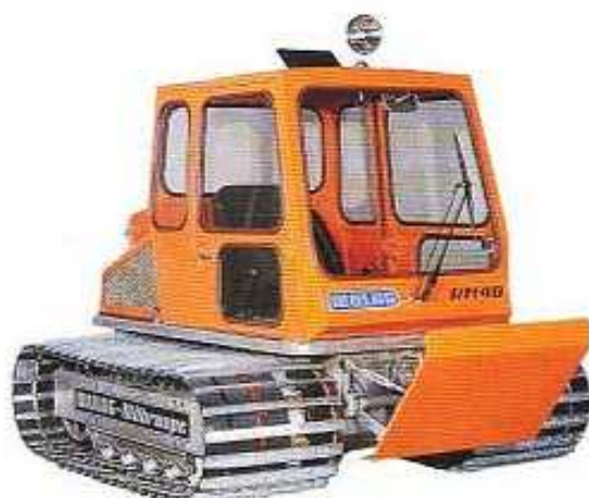
RM 40 avec équipement d'hiver, cabine de protection et lame avant.
