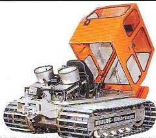
RM 40 avec train de chenille neige et treuil de dépannage. Le compartiment de transmission ouvert montre, combien l'accès est facile pour l'entretien.
