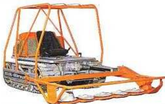
RM 40 avec faucheuse à disques sans tablier avec cadre de protection.
