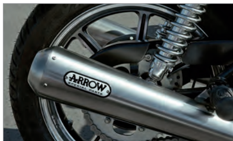
LIGNE ARROW 2 EN 2* Ligne complète, titane, gain de poids de 44% comparé aux échappements d'origine. Courbe d'injection spécifique à télécharge.
