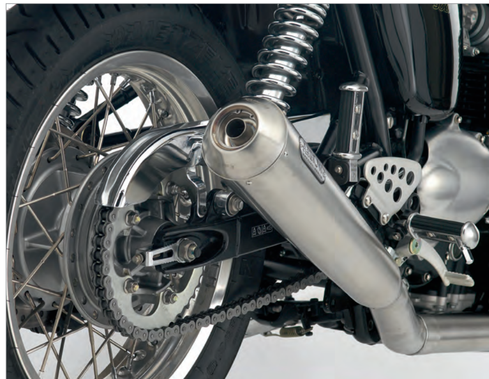
LIGNE ARROW 2 EN 1* Ligne complète, titane, gain de poids de 62% comparé aux échappements d'origine. Courbe d'injection spécifique à télécharger.
