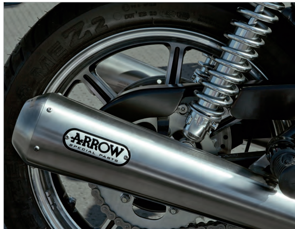
LIGNE ARROW 2 EN 2* ✂ 1.5 % A1 Ligne complète, titane, gain de poids de 44% comparé aux échappements d'origine. Courbe d'injection spécifique à télécharger. €1369 A9600075
