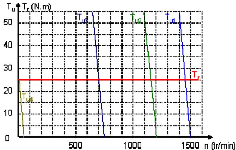
Pour le moteur asynchrone utilisé, le nombre de pôles est 4. On fait varier à la fois la fréquence  $f$  et la valeur efficace  $U$  des tensions statoriques, en conservant le rapport  $U/f$  constant. Le moteur entraîne une charge de couple résistant  $T_r$  constant. L'expression du couple électromagnétique peut se mettre sous la forme:  $T_{em} = kT_{em,max} \cdot (n_s - n)$  où  $T_{em,max}$  est la valeur maximale de  $T_{em}$ , et  $k$ , une constante dépendant du moteur.
