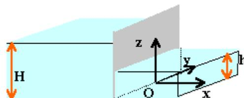
Une porte d'écluse de largeur  $L$  retient de l'eau liquide supposé incompressible de masse volumique  $\rho$ .
