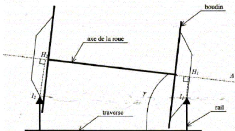
On suppose que le plan est horizontal : la traverse est horizontale et les rails verticaux. Le point de contact du rail n°1 ( respectivement n°2) avec la roue est noté  $I_1$  ( respectivement  $I_2$ )  $L = I_1 I_2$ .  $H_1$  ( respectivement  $H_2$ ) est le projeté orthogonal de  $I_1$  ( respectivement  $I_2$ ) sur  $\Delta$ . On a donc  $r_1 = I_1 H_1$  et  $r_2 = I_2 H_2$ .  $\Delta$  fait un angle  $\gamma$  avec l'horizontale.
