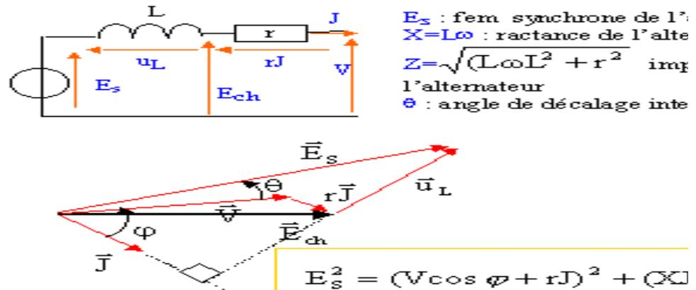
montage étoile : la tension aux bornes d'un enroulement est  $2500 / \sqrt{3}$  V
