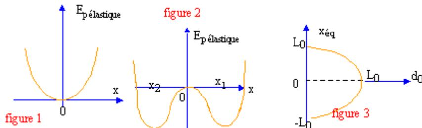
figure 3 : en trait plein les positions stables d'équilibre ; en pointillés les positions instables
