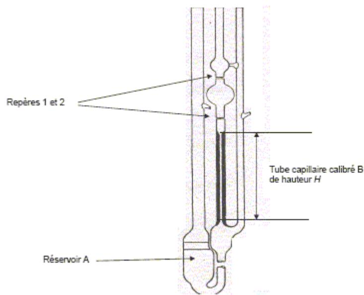
Ce viscosimètre contient un tube capillaire calibré B placé verticalement dans une cuve thermostatée. On introduit le fluide à étudier dans le réservoir A, et on mesure le temps que met le volume V de fluide contenu entre les repères 1 et 2 pour s'écouler à travers le capillaire.
