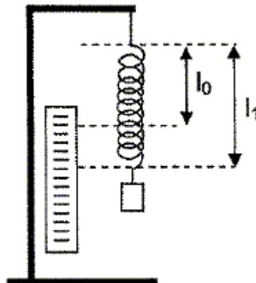
Un solide de masse  $m$  accroché à l'extrémité libre d'un ressort constitue un pendule élastique. On étudie l'équilibre de ce solide. Utiliser le dispositif ci-dessus, accrocher les différentes masses marquées à l'extrémité du ressort, noter les longueurs  $l_1$  prises par le ressort. Compléter le tableau ( $g = 9,81 \text{ N/kg}$ ).
