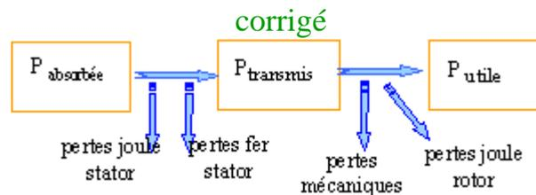
les pertes par effet joule dans le rotor sont égales au glissement fois la puissance transmise .
