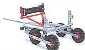
Remorque à billons, peut être équipée d'un rouleau d'éclaircie.
